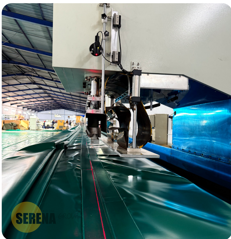
Saldatrice ad alta frequenza su tavolo lungo 30 metri
